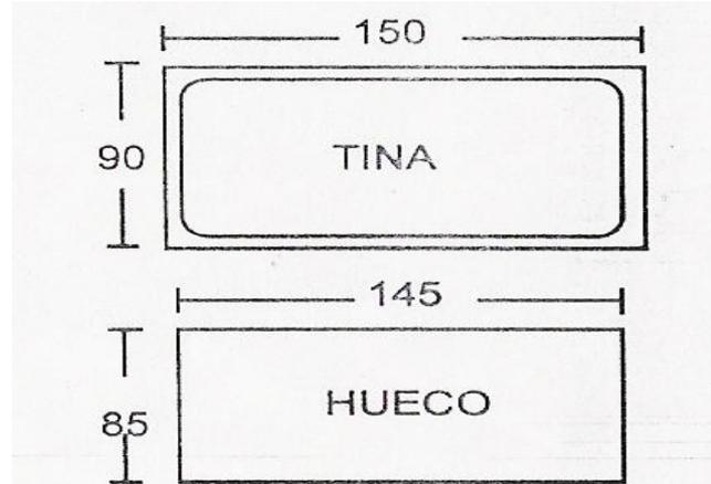
7.- La tina deberá ser soportada en todo el perímetro del labio y el piso sobre una cama de arena cernida cuidando que la altura de la misma permita descansar el labio de la misma.
